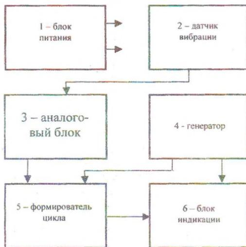
Рис. 1 - Увеличенная функциональная схема виброакустического цифрового индикатора ДИКОН.
